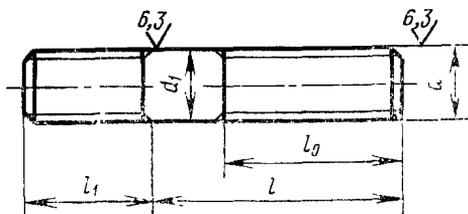
Примечание. Допускается изготовление шпилек с диаметром стержня приблизительно равным среднему диаметру резьбы. В обозначении этих шпилек после слова «Шпилька» следует указывать цифру 2.
